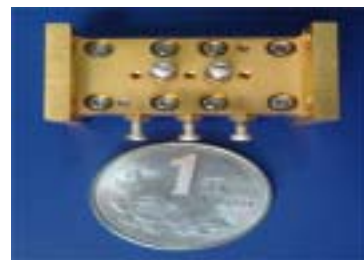
图10 梳形滤波器外形图
